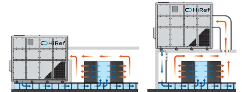
Verwendungsbeispiel für ein Rechenzentrum mit 1 MW (Redundanz N+1) in Amsterdam @ 36 °C - 25%, T Austrittsluft 24 °C, Max T Austrittsluft 26 °C
